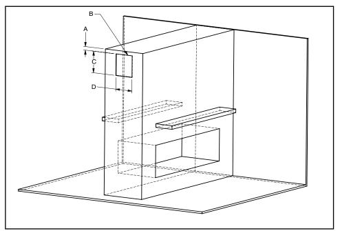
2" (51 mm) max. 120 sq. in. min. С 4" (102 mm) min. 10" (254 mm) min.
