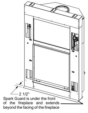
FIGURE 6 SPARK GUARD INSTALLATION
